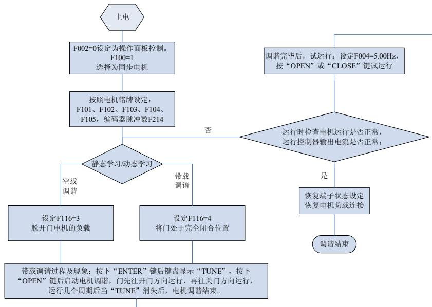
图7-2 交流永磁同步电机调谐流程图
