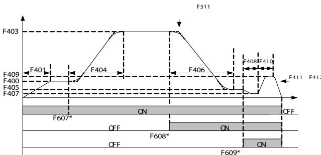
图6-6 异步门刀距离控制关门曲线示意图
