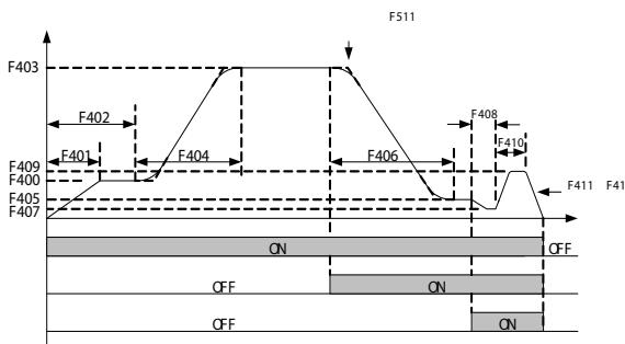
图6-5 速度控制关门曲线示意图
