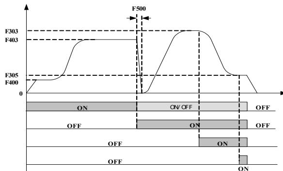
图7-8 距离控制方式遇阻运行曲线图
