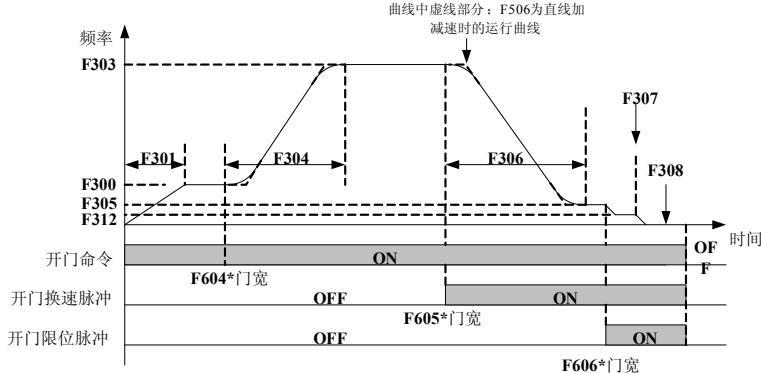
图6-4 距离控制开门曲线示意图
