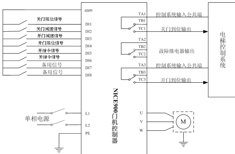
图7-4 速度控制系统典型应用接线图
