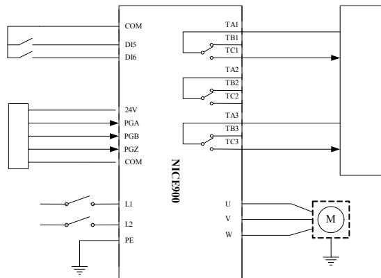
图7-7 距离控制方式（全脉冲）应用接线方式
