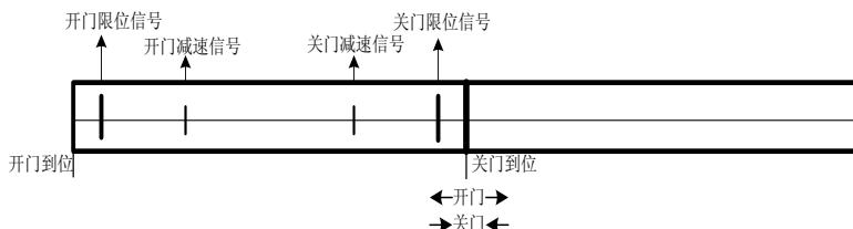
图6-2 速度控制各开关安装示意图
