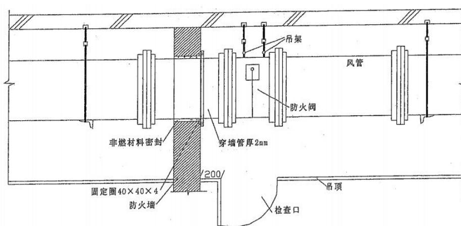
图 10 防火阀检修口设置示意图
