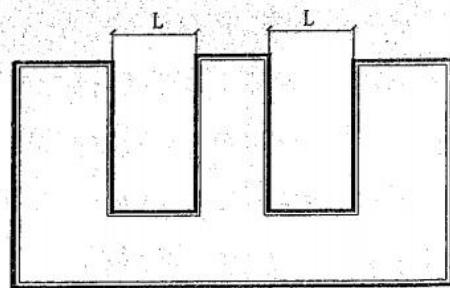
3.4.8 除高层厂房和甲类厂房外，其他类别的数座厂房占地面积之和小于本规范第 3.3.1 条规定的防火分区最大允许建筑面积（按其中较小者确定，但防火分区的最大允许建筑面积不限者，不应大于  $10000m^2$ ）时，可成组布置。当厂房建筑高度不大于 7m 时，组内厂房之间的防火间距不应小于 4m；当厂房建筑高度大于 7m 时，组内厂房之间的防火间距不应小于 6m。
